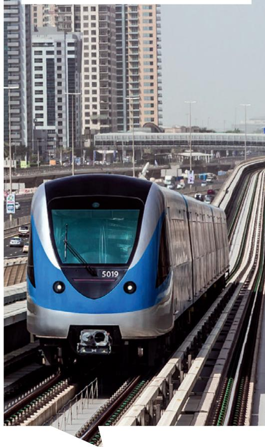
Vollautomatische Zugsteuerung stellt besondere Anforderungen: Das U-Bahn-Netz in Dubai wird gänzlich fahrerlos betrieben
